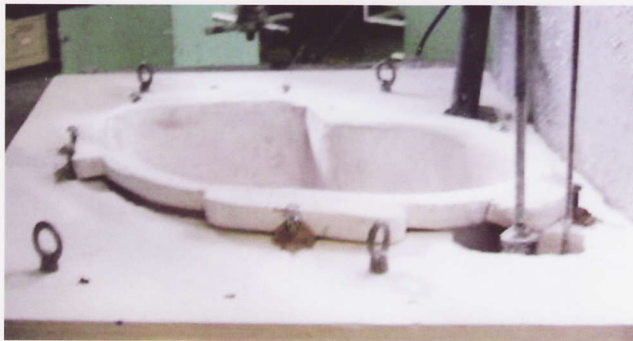
炉蓋設置状況
